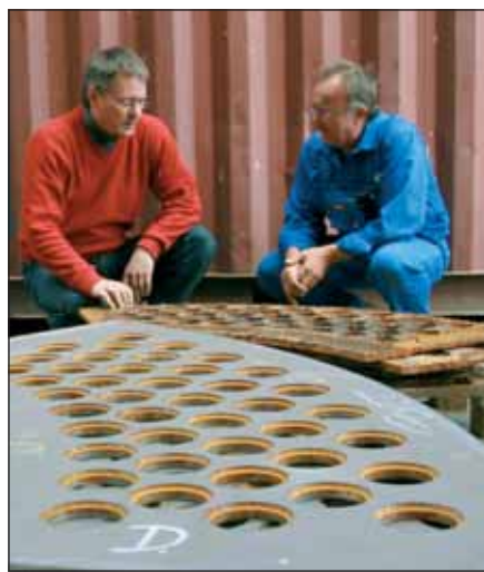
Direktør Jan Clement og reparatør Henning Mortensen ser på den gamle, rustne topplade, som udskiftes med de nye topplader i forgrunden.
